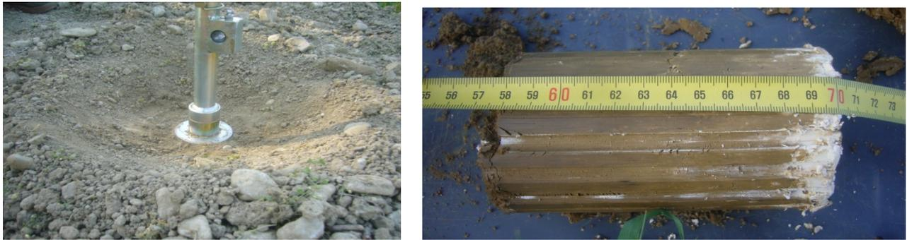
Abbildung 5: Bodenbohrer zur Entnahme der Profilproben (li). Bodenbohrkern (re).
