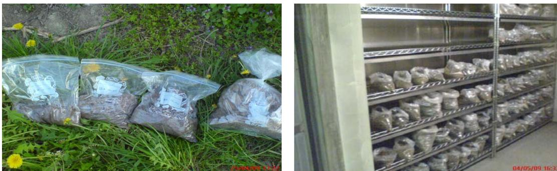
Abbildung 6: Bodenproben vor Ort dicht verpackt (li). Bodenproben beim Trocknen (re).
